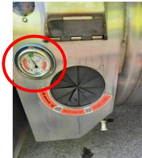
Manomètre et pictogramme gaz inflammable sur le réservoir
